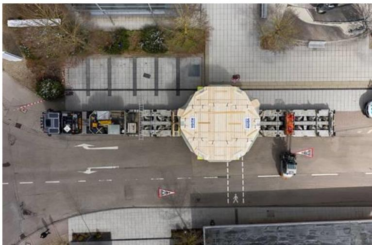
Mit über 8 Metern Durchmesser verlässt der Stator für das Kraftwerk Töging am Inn als bislang breiter Transport in der Geschichte von Voith Hydro Heidenheim das Werksgelände.
