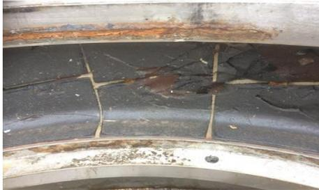
Die Basalt-Innenverkleidung von CombiSortern musste jedes Jahr ausgetauscht werden. Um dem entgegenzuwirken, hat Voith jetzt eine spezielle Gussstahl-Legierung entwickelt.
