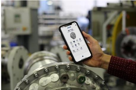
TurboGuide Mobile ermöglicht den einfachen Zugriff auf alle Kupplungsdaten wie Füllvolumen, Füllwinkel, Leistung, Drehzahl oder Betriebsflüssigkeit.
