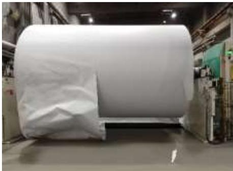
Mithilfe des TailFix können Papierenden zuverlässig fixiert werden. Auf dem Bild sieht man links den Zustand ohne Außenlagenverklebung und rechts den optimierten nach der Verwendung des automatischen Leimauftragssystems TailFix.
