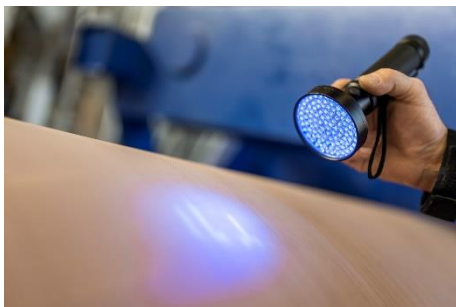
Der QView Pressmantel von Voith macht aufgrund seiner besonderen Eigenschaften und der Verwendung von UV-Licht unsichtbare Risse im Pressmantel sichtbar.
