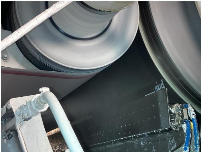
Optimale Konditionierung der TerraSpeed Supreme mit SkyTop Plus sorgt für eine hervorragende Blattabgabe und stabile Rauigkeitswerte
