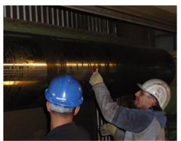
Vor der Installation der TerraDry PN musste die verchromte Stahlwalze bei jedem Stillstand gereinigt werden.
