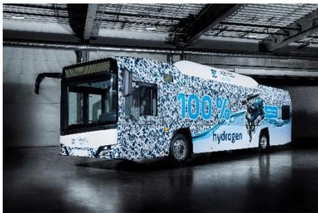
Das Fahrzeug ist mit einer einzigartigen Kombination aus "KEYOU-inside Wasserstoffmotor" und Voith DIWA NXT Mild-Hybrid-System ausgestattet.
