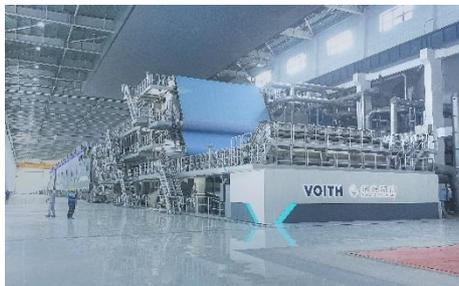
Die PM 6 verfügt über eine Breite von 7,92 Metern und eine Konstruktionsgeschwindigkeit von 1.400 Metern pro Minute.
