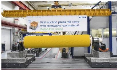
SolarFlow Green von Voith ist der erste Saugpresswalzenbezug, der nach DIN CERTCO für biobasierte Produkte zertifiziert ist.
