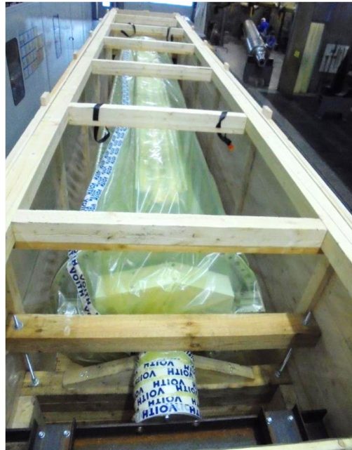
Abbildung 6: Ausführung Deckeldruckholz und Deckeldruckholzstütze
