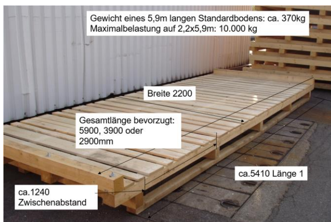
Abbildung 4: Maße und Ausführung offener Boden
