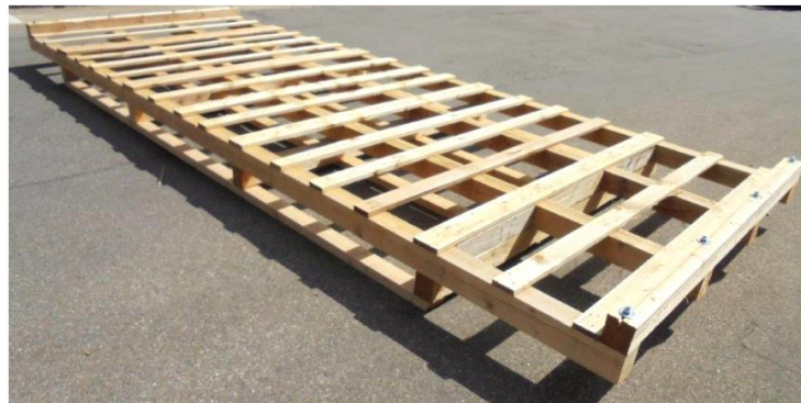
Abbildung 3: Boden in offener Ausführung
