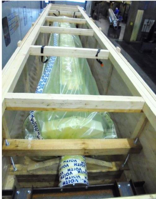
Abbildung 6: Ausführung Deckeldruckholz und Deckeldruckholzstütze
