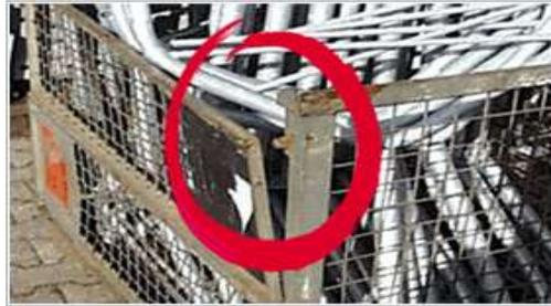
→ der Bodenrahmen oder die Füße sind so verbogen, dass die Gitterbox nicht mehr gleichmäßig auf 4 Füßen steht
