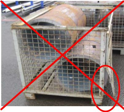
Gitterbox zu schwer, nicht mehr stapelbar, Gitterbox wird auseinander gedrückt. Das Material steht über die Gitterbox.
