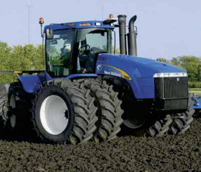
Off Road-Anwendung CNH4x4 Tractor mit Iveco Motor Cursor 13 TCD
