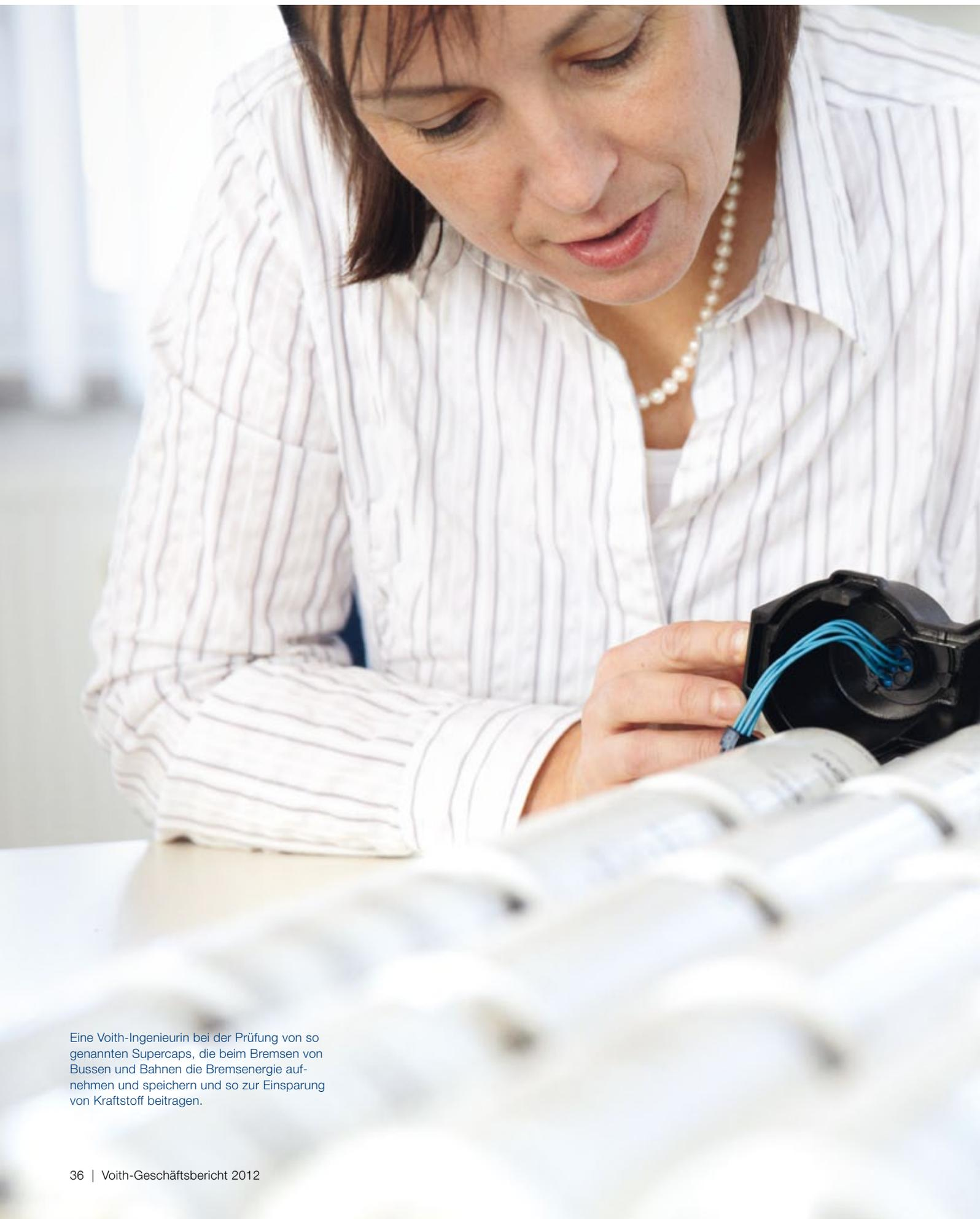
Eine Voith-Ingenieurin bei der Prüfung von so genannten Supercaps, die beim Bremsen von Bussen und Bahnen die Bremsenergie aufnehmen und speichern und so zur Einsparung von Kraftstoff beitragen.
