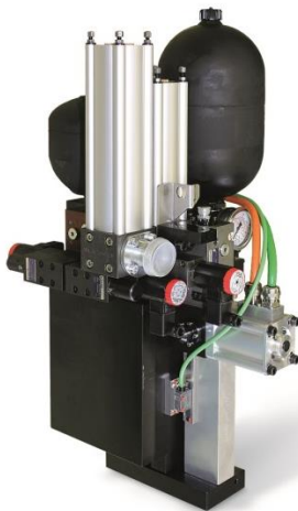
Bild 2: Hydraulische Hubsteuerung für Stanzmaschinen mit DECV Ventil. Die Zykluszeit bei einem Hub von 4 mm beträgt 18 ms.
