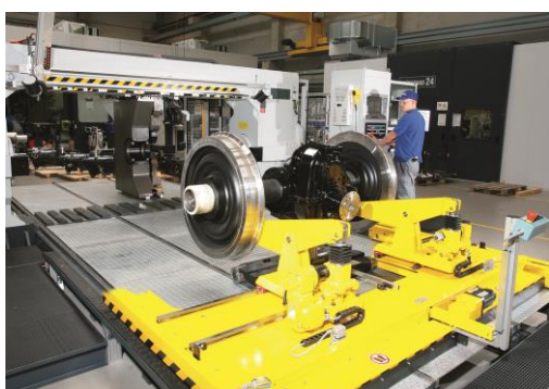
Mit der Radsatzpresse in Heidenheim fügt Voith Radsätze
