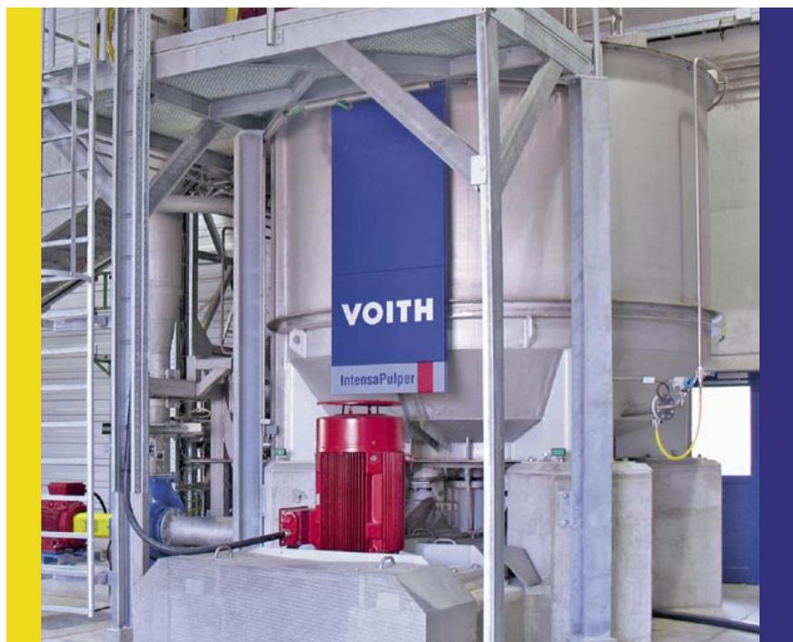
Гидроразбиватель IntensaPulper IP-V в работе.
