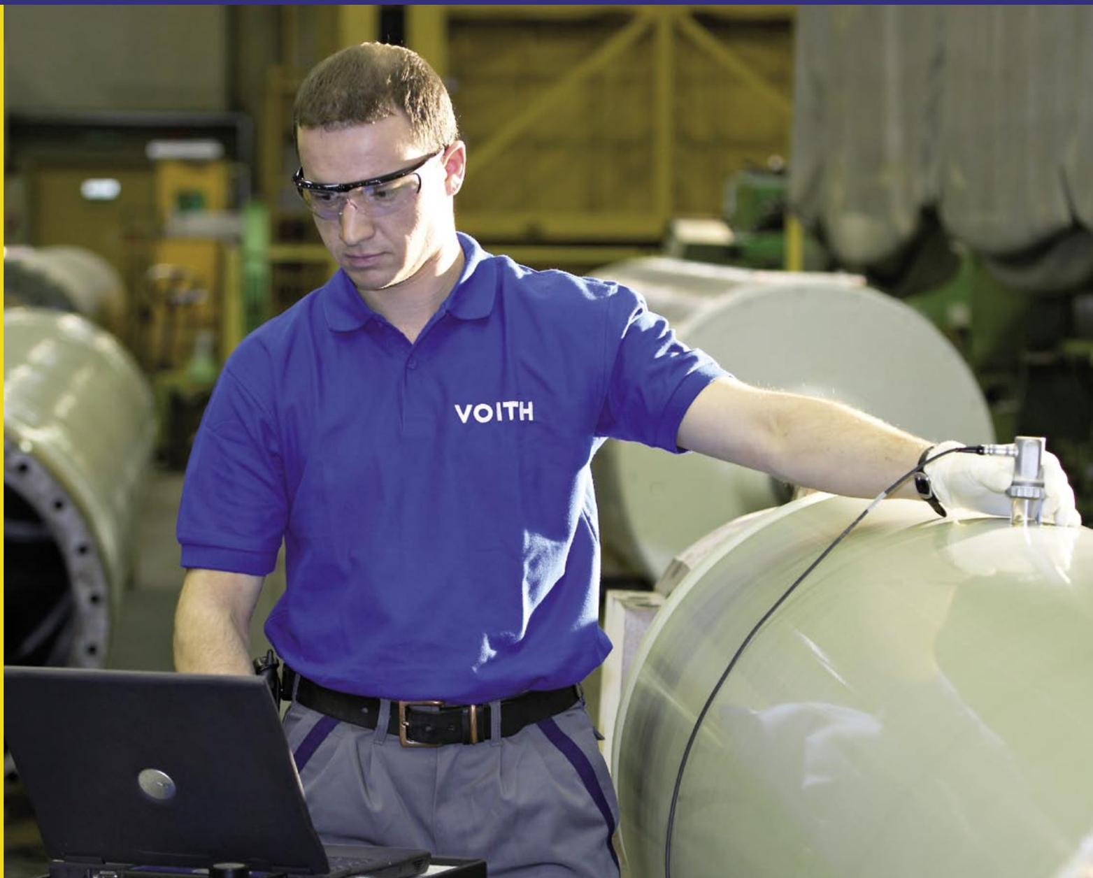
*RollCare: Ультразвуковая дефектоскопия покрытия вала.*
