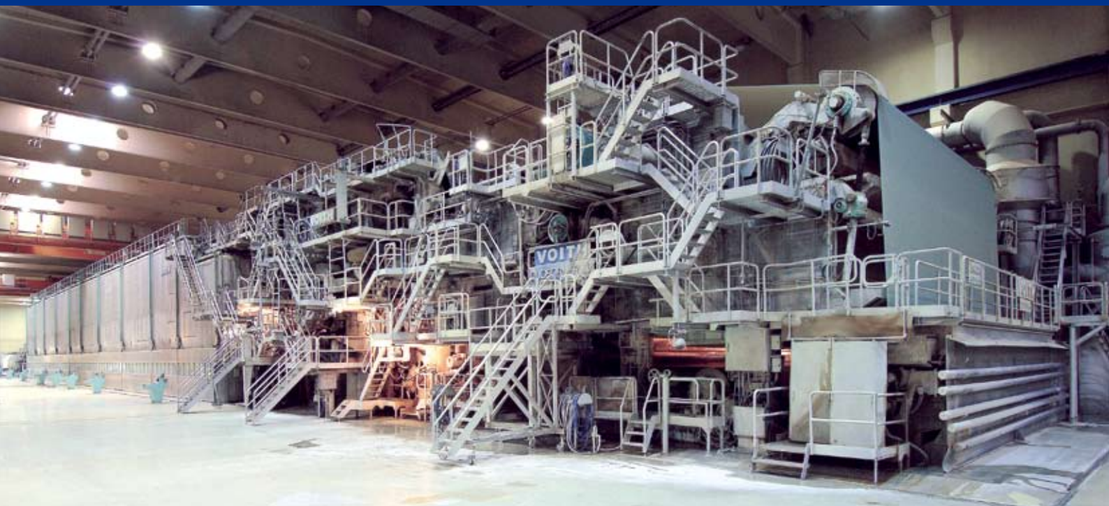
UPM Steyrmühl 纸厂 4 号纸机成形部被改造成了新式的 DuoFormer CVB 型
