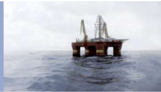
福伊特的径向螺旋桨通过动力定位来保持近海浮动平台的稳定——无论天气情况如何
