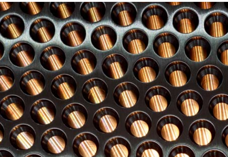
定制：多个钻头在二联钢上钻出抽吸孔
