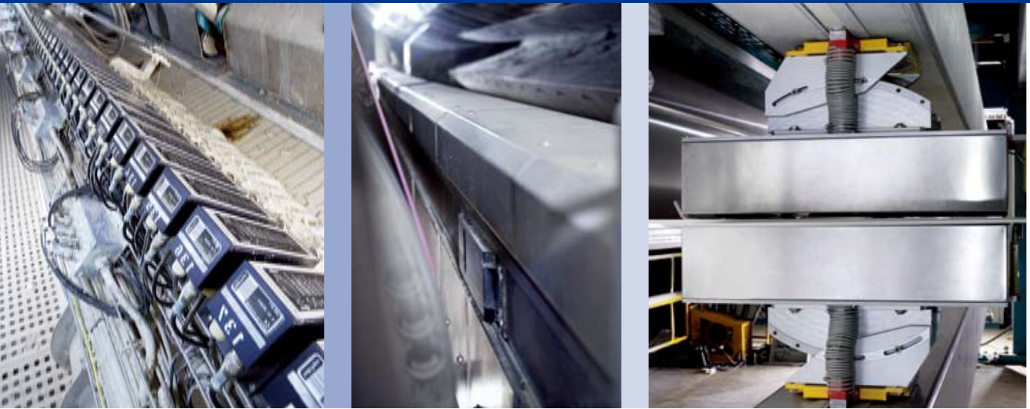
从流浆箱一直到卷取机的连续的质量控制系统：OnQ ModuleJet、OnQ EnviroScan 和 OnQ Scanner
