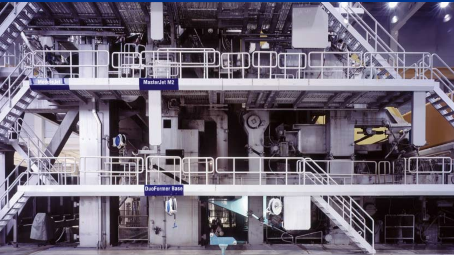
全球正在运行的纸板与包装纸生产用的 40 台夹网成形器之一——落户于 Jass Schwarza 的 DuoFormer Base
