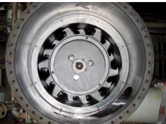
用 MultiFoil 转子和 C-bar 筛筐对 TLA 450 型筛进行改造
