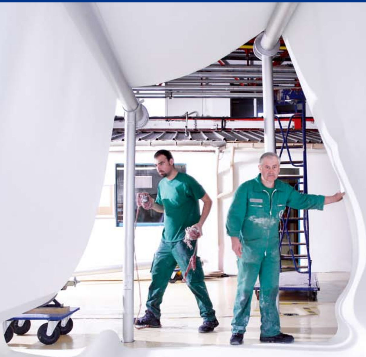
在 Docelles 纸厂进行毛布更换：下毛布准备装到压榨部当中
