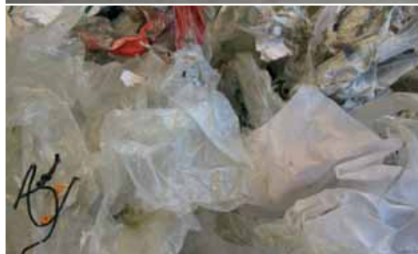
Abb. 6: Normale Störteile, die der IntensaMaXX separiert und die aus der nachgeschalteten Sortiertrommel ausgeschieden werden.
